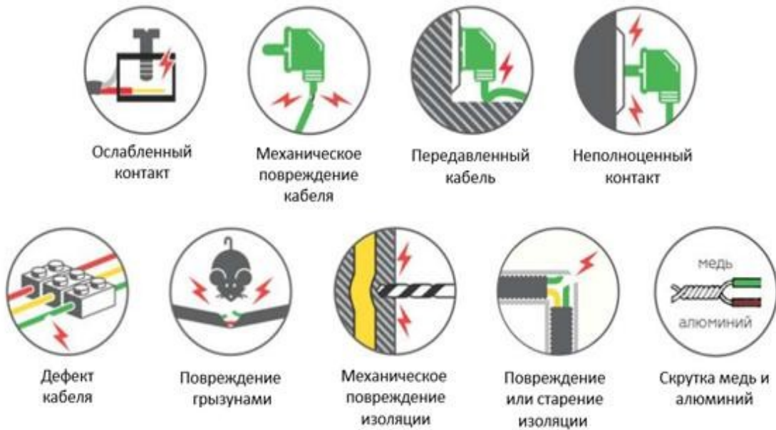
Рисунок 6. Возможные причины искрения в электропроводке
