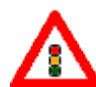
1.8 "Светофорное регулирование" Перекресток, пешеходный переход или участок дороги, движение на котором регулируется светофором.
